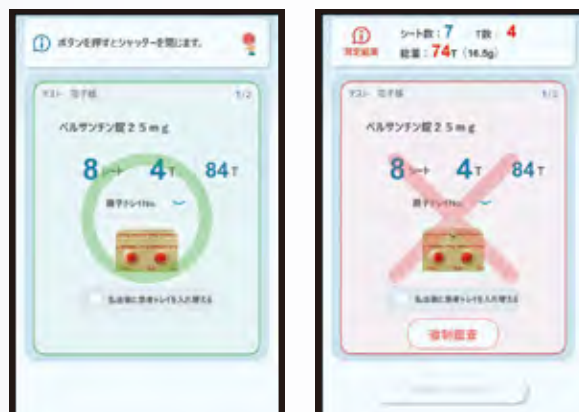
重量鑑査を行い、ピッキング詳細モニターに大きな「○」、「×」を表示します。重量が合っている場合は「○」表示になります。
