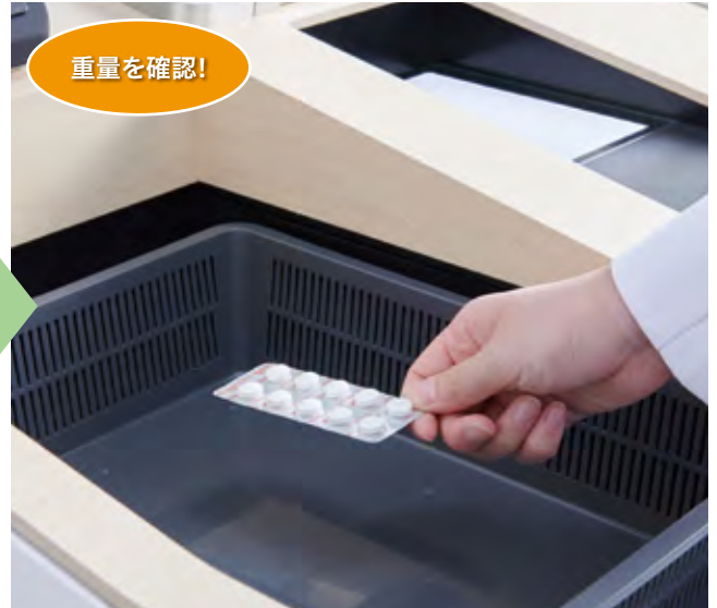
シート重量を測定し、重量鑑査。
