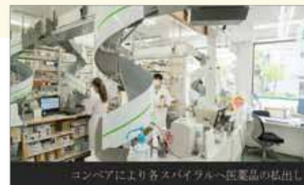
図2／薬剤師のもとにスパイラルコンベアで医薬品の払い出し
