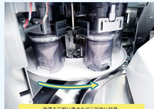
散薬を円盤に撒きながら同時に秤量。 秤量中に次に配分する薬品のカセットをロボットが用意。
