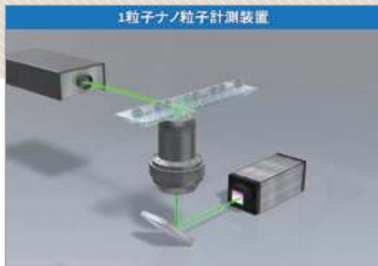
図3／レーザー光線を使ったナノ粒子計測装置
